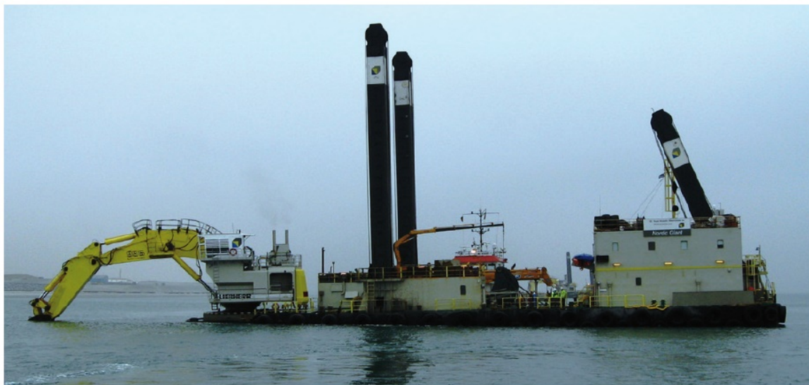
Figur 3-8 Typisk grävmaskin/mudderverk för dikning på grunt vatten.
